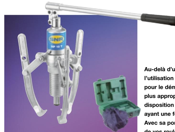
Au-delà d'une certaine dimension, l'utilisation d'un extracteur mécanique pour le démontage des roulements n'est plus appropriée. SNR met donc à votre disposition un extracteur hydraulique ayant une force d'extraction de 10 tonnes. Avec sa pompe intégrée, le démontage de vos roulements devient un jeu d'enfant.
