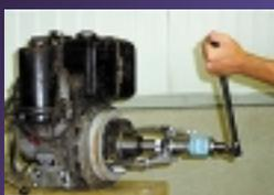
Avec l'extracteur hydraulique SNR, l'opérateur a uniquement besoin d'une pompe. De manière très simple, il peut accumuler une puissance élevée.
