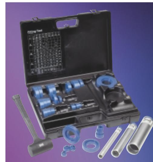
Le montage des roulements est une opération délicate qui nécessite des outils adaptés. Pour bien monter un roulement, les chocs doivent toujours s'exercer sur la bague serrée sur l'arbre ou dans le logement selon les types de montage. Les outils de montage SNR vous permettront de conserver la qualité des chemins du roulement grâce à l'appui sur les bagues intérieures ou extérieures, des joints et des cages grâce aux douilles et tubes adaptés au diamètre de vos roulements.
