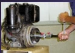
Parce que la broche de l'extracteur mécanique doit tourner, l'opérateur a besoin de beaucoup de couple pour détacher la pièce.
